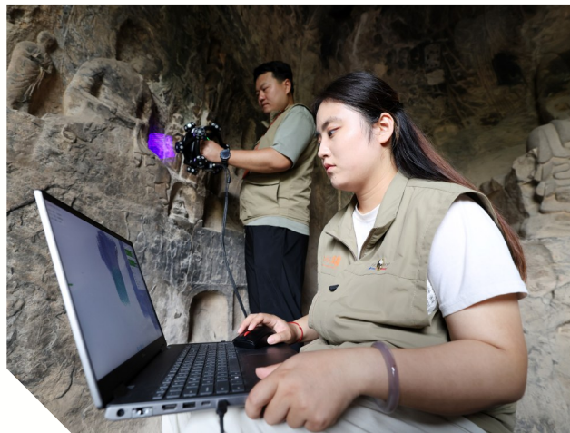
(左图)5月12日,龙门石窟研究院工作人员在洞窟内使用跟踪式扫描仪采集文物数据。 新华社记者 李嘉南 摄
