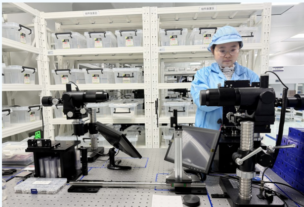
▲ 2月24日，在位于北京市昌平区国际医疗器械城的图湃医疗北京产业总部几何光学系统装调间内，光学装调师正在装调精密镜头组。 受访者供图
