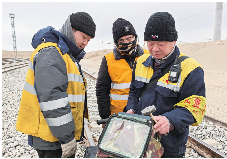
格尔木探伤检查工区工作人员在达布逊开展钢轨设备探伤检查工作。
