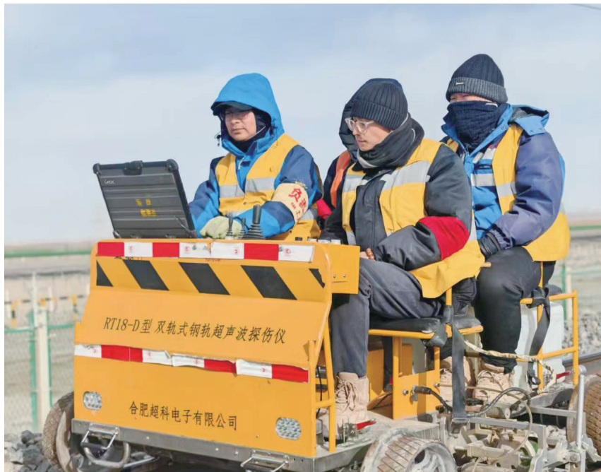
格尔木工务段探伤车间职工对铁轨进行探伤作业。
