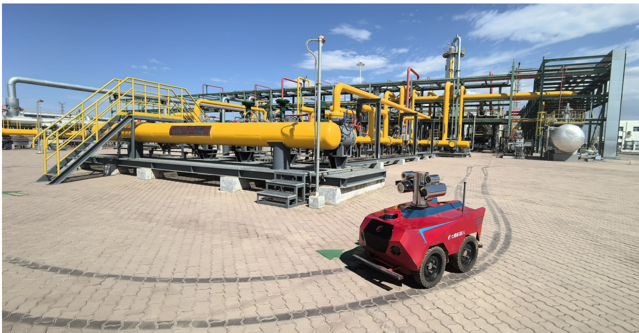
11月10日,温吉桑储气库群内,智能巡检机器人正在站内巡检。
