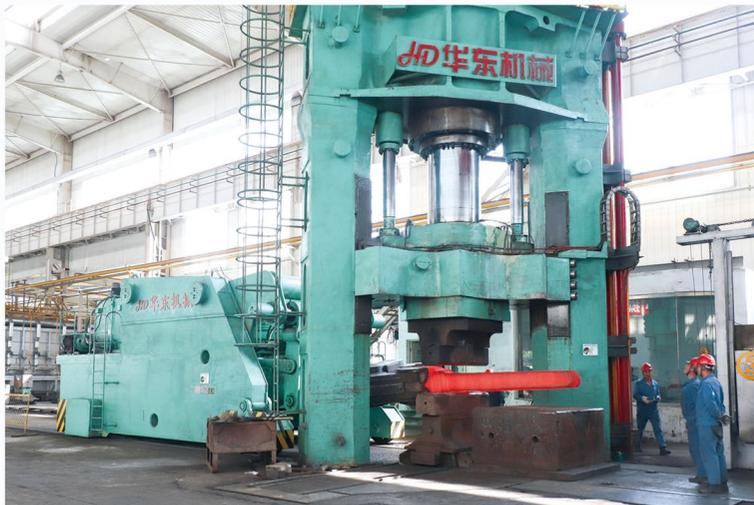
2500T快锻机组，配备25T操作机，具备连续锻和快锻功能，主要用于各类材料的自由锻件生产。
