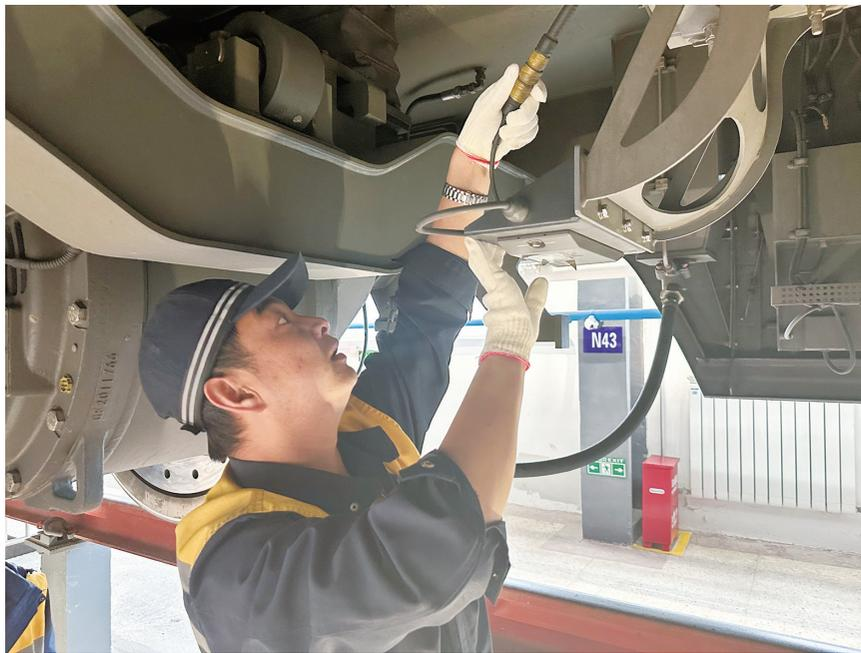
另一边,职工董宝军正在检查车底外部挂件,他猫着腰,用手电筒仔细查看挂件螺丝是否松动,固定支架有无开焊、虚焊,车底电缆是否破皮松绑。发现稍有不达标的问题,他立即细心整治。
