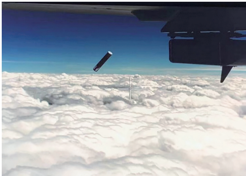
这是此次试验的投放监控实况图，图中圆柱体为下投式探空仪。
